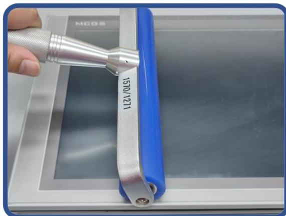
4) 贴完膜后可使用滚轴将膜背胶压实，避免产生气泡
