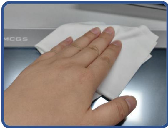
1) 清洁屏幕，使用防尘布擦除屏前面板脏污，避免贴膜时起泡。若TPC表面污染严重，可使用清洁剂辅助清洁
