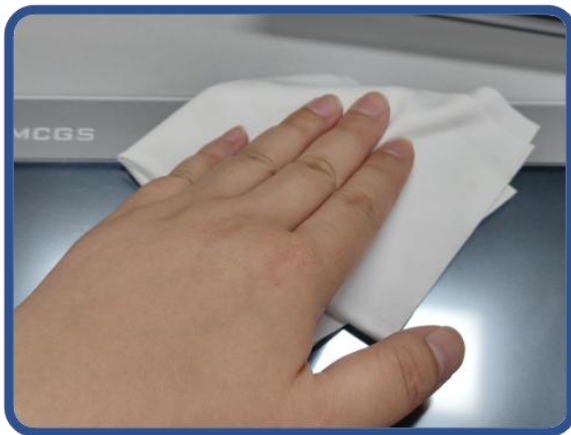
1) 清洁屏幕，使用防尘布擦除屏前面板脏污，避免贴膜时起泡。若TPC表面污染严重，可使用清洁剂辅助清洁
