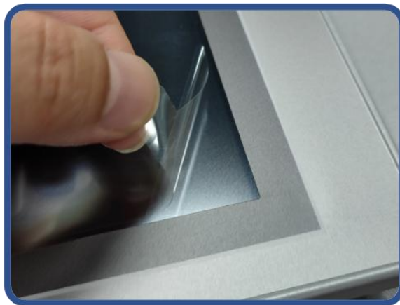
2) 撕除出厂PET保护膜，清洁原PET保护膜四周缝隙处的污染物
